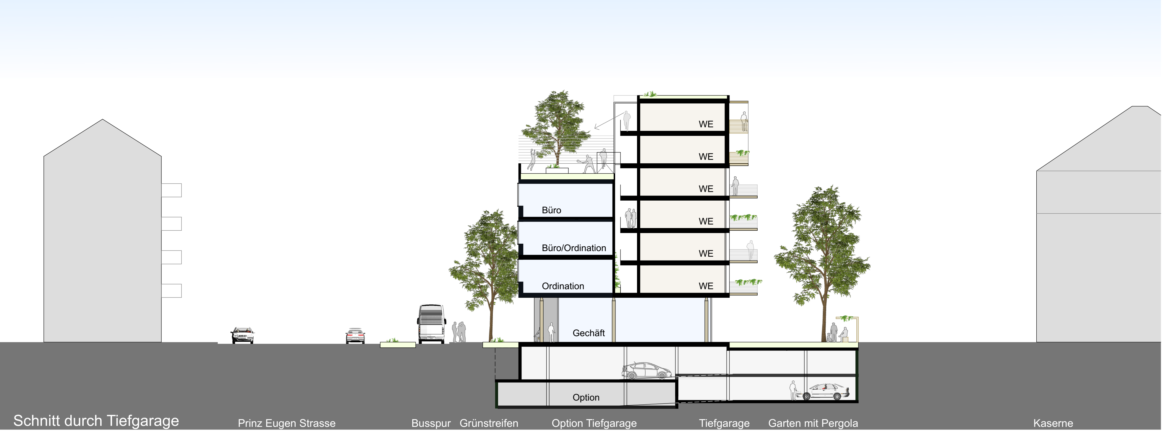
Schnitt durch Tiefgarage
